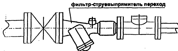
Установка фильтра-струевыпрямителя перехода перед турбинным счетчиком
